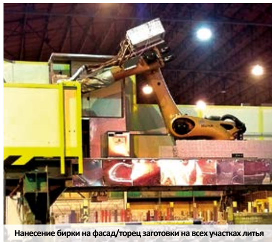
Успешно приварено при помощи PIN-технологии на неровных поверхностях с изгаринной
